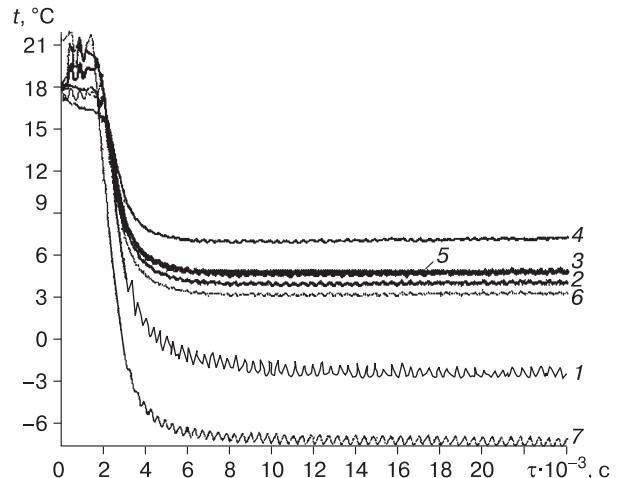
Рис. 3. Изменение температуры ( $t$ ) вдоль испарителя ( $\tau$  – время).
