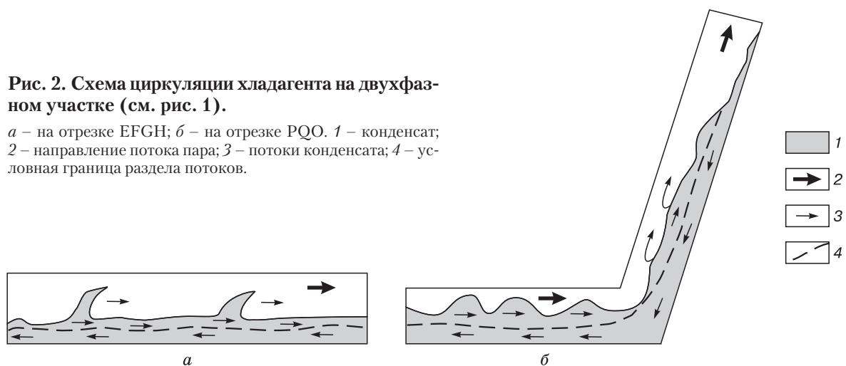
волнообразной поверхностью конденсата во вставке ④ (см. рис. 2, б). Однако постоянно наблюдающийся во вставке ③ обратный поток говорит в пользу изображенной на рис. 2, б картины движения на участке QO.
