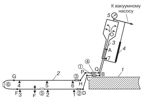
**Рис. 1. Схема лабораторной модели охлаждающего устройства с горизонтальной испарительной частью.**
