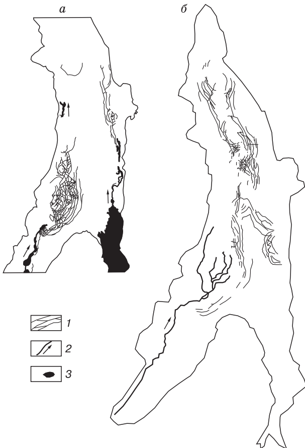
Рис. 1. Трещины просадок на ледниковом завале 26.06.2003 г. (а) и 7.07.2004 г. (б).
